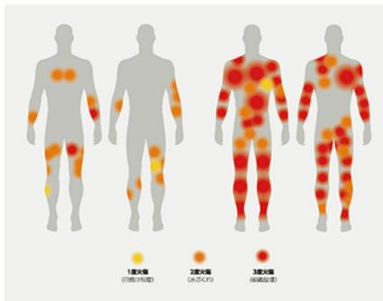
燃焼マネキンによる火傷評価システム
