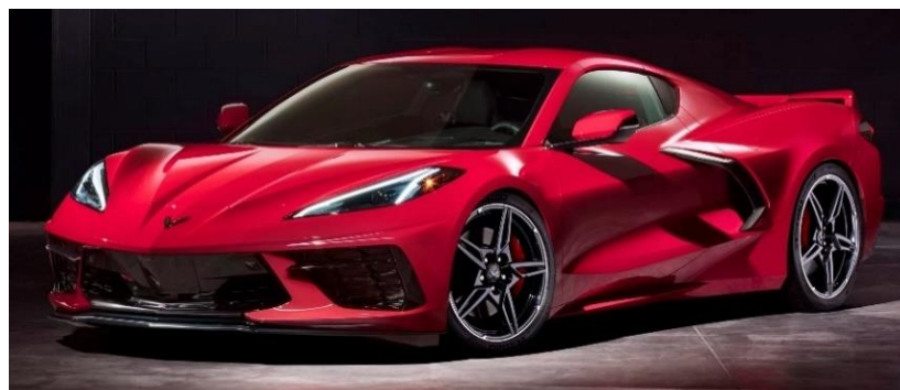
GM Chevrolet Corvette ドア、フェンダー等のボディパネル類 (ガラス繊維複合材料)
