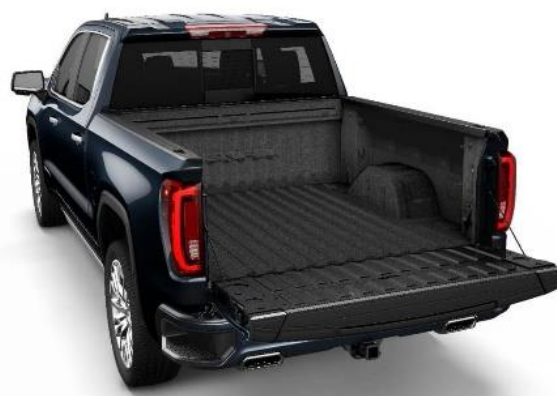
GMC Sierraの荷台「Carbon Pro」 の内側の大型パネル・床材 (CFRTP*2、「Sereebo」) 2019年のSPE Innovation Award を受賞
