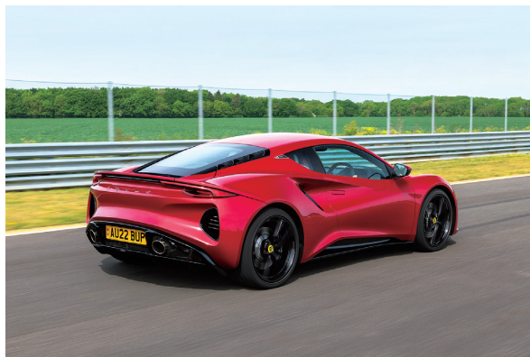
ロータスのSMC製ドアとテールゲート
