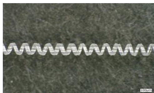
「SOLOTEX ECO-Hybrid」のクリンプ構造
