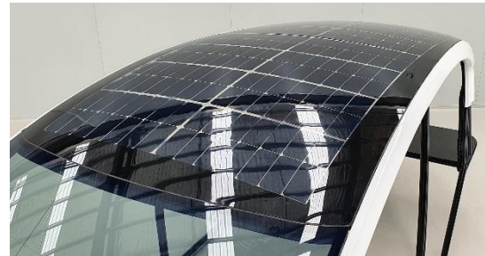
左：共同開発したソーラールーフ搭載のAEV社製LS-EVプロトタイプ 右：ソーラールーフ
