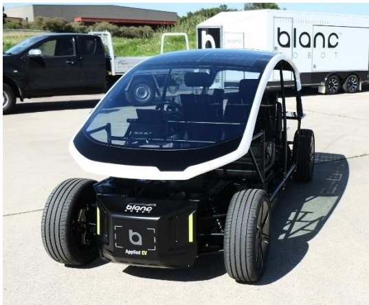
左：共同開発したソーラールーフ搭載のAEV社製LS-EVプロトタイプ 右：ソーラールーフ
